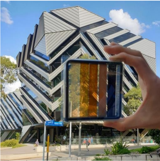
图6：半透明钙钛矿太阳能电池
