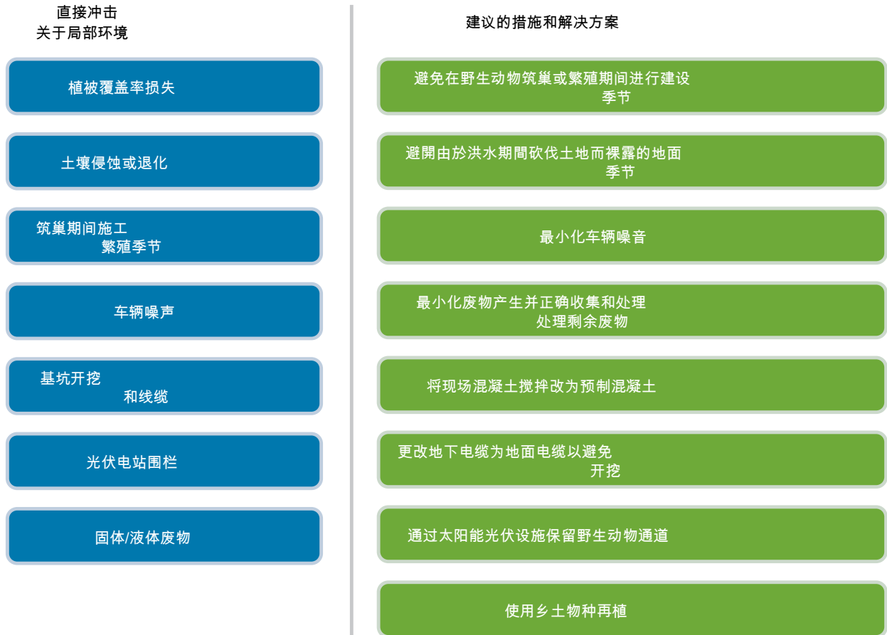
图15 施工过程中避免和减轻影响措施
