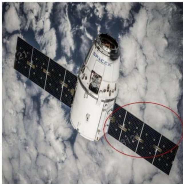
图：电源系统是卫星中重量与成本占比最高的核心单元之一
