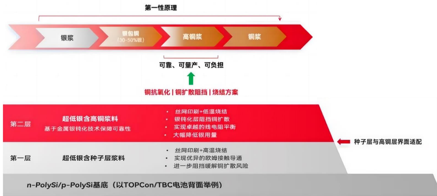
图2.1.3：帝科TOPCon、TBC电池少银金属化浆料解决方案
