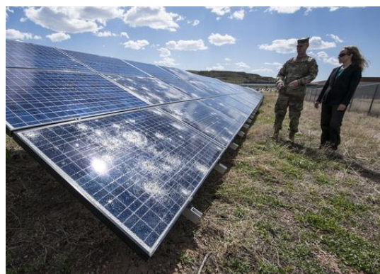
图9：科罗拉多州的一个太阳能电池板被创纪录的冰雹风暴损坏，影响了25-50%的现场光伏组件。照片：丹尼斯·舒勒德 /NREL。
