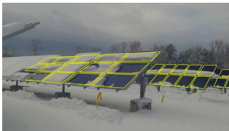
图20：单轴跟踪器的光伏组件上的积雪。黄色四边形表示为分析非均匀掉落模式而对组件进行的分割。照片来源：劳里·伯恩哈姆。
