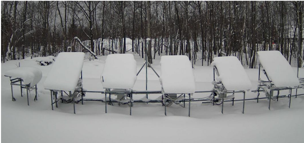
图18：美国密歇根州卡卢梅特市的密歇根州新兴太阳能技术实时测试中心测试阵列。正在进行一项比较可靠性分析，针对六种不同的组件技术，其尺寸、电池尺寸、前玻璃和背板各不相同，并对每个组件进行雪载荷、风载荷、挠度、温度和直流功率的监测。在每个冬季结束时，所有组件都使用电致发光成像进行裂纹评估。图片来源：L. 烧恩哈姆。
