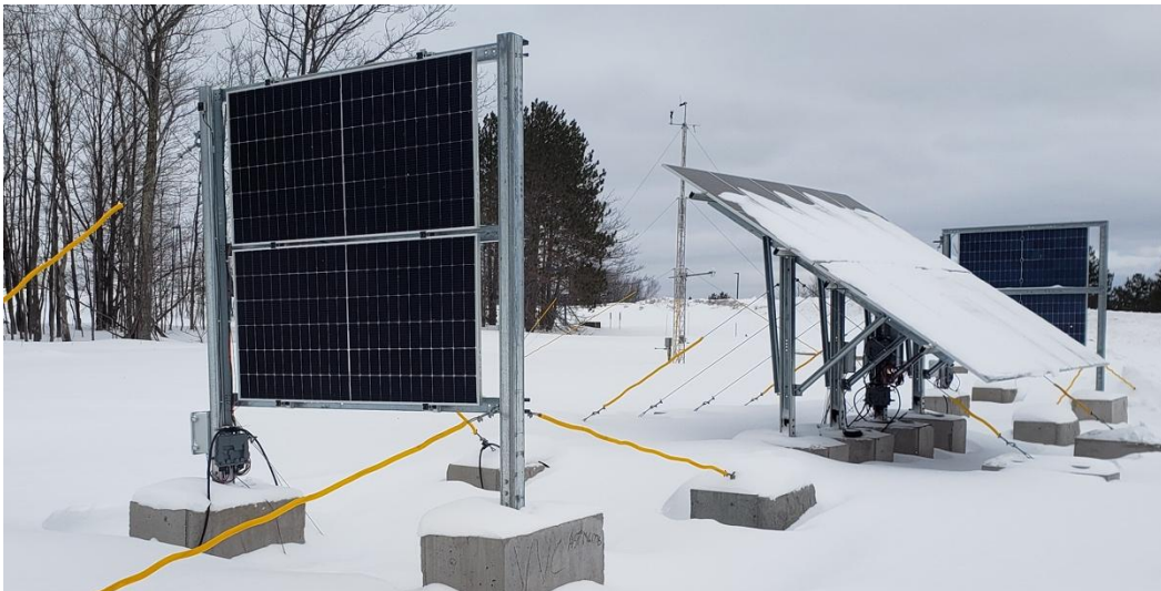
图 19：桑迪亚国家实验室在密歇根 RTC 安装的混合朝向系统示例。正在进行对朝南固定倾角与垂直朝东和朝西的双面组件相对性能的分析，这些组件几乎不收集雪。图片来源：保尔·戴斯
